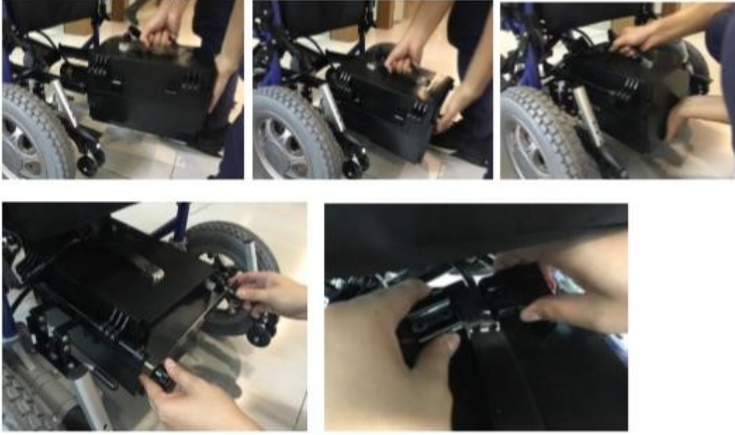
Şekil 10: Akünün Ürün Üzerine Takılması İşlemi
